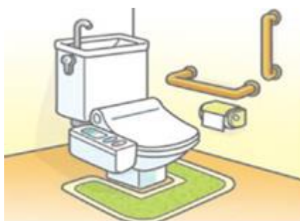
手すりの設置
